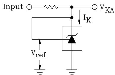
FIGURE 2-TEST CIRCUIT FOR  $V_{KA} > V_{ref}$
