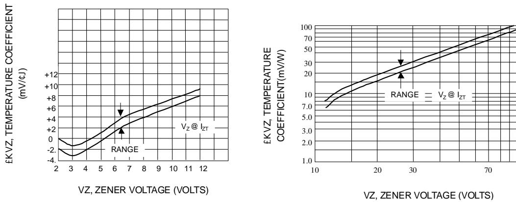
Fig. 2-TEMPERATURE COEFFICIENTS
