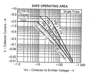
COLLECTOR CURRENT vs. COLLECTOR TO EMITTER VOLTAGE
